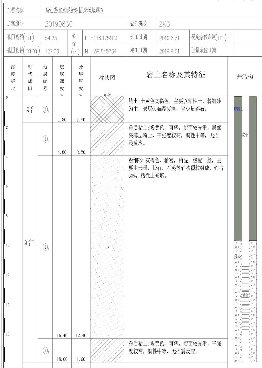
图 7.3-6 ZK3 钻孔柱状图
