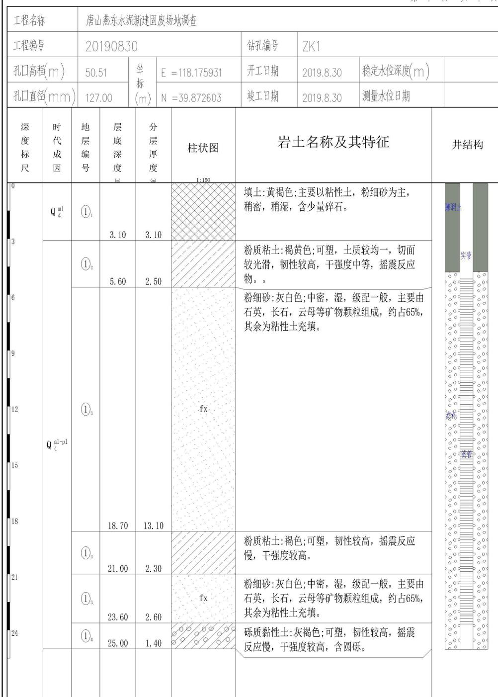
图 7.3-4 ZK1 钻孔柱状图
