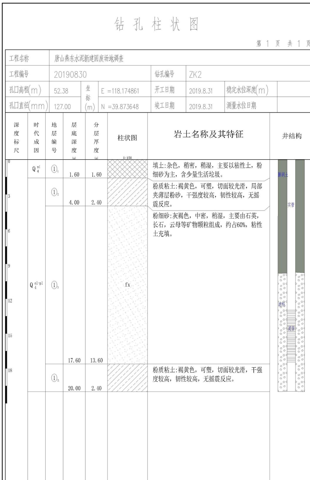
图 7.3-5 ZK2 钻孔柱状图
